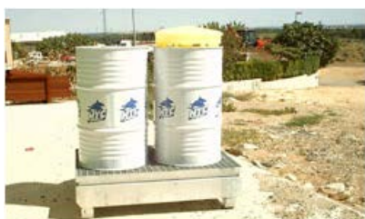
Bac de rétention sous les fûts
