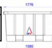
**TOLE** : Epaisseur 3mm nervurée au pas de 215 mm. Les nervures remplacent les cornières pour alléger le poids du caisson et augmenter la charge utile. Les nervures allongent aussi la durée de vie des caissons car les déchets ou leur jus ne restent pas coincés entre la tôle et la cornière.
