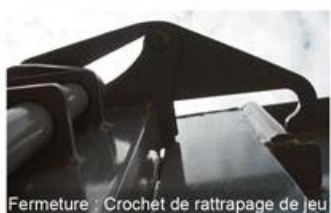
Fermeture : Crochet de rattrapage de jeu
